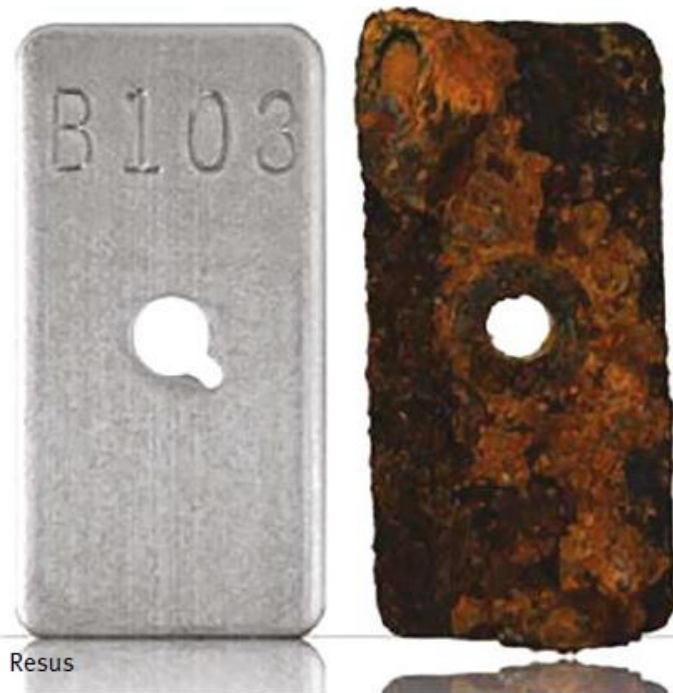
Fig. 6 Exemples de coupons-témoins en acier.
