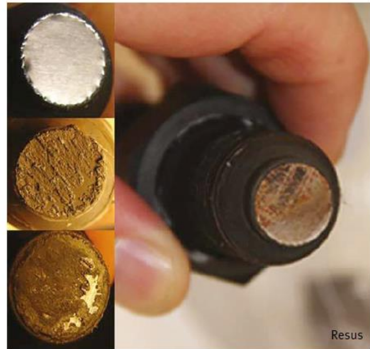
B. Coupons-témoins de forme circulaire à monter sur une sonde rétractable
