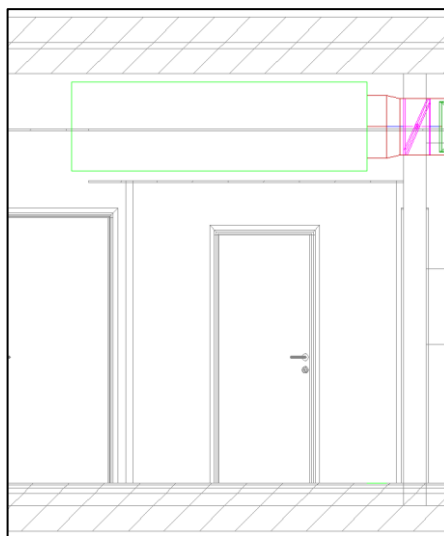
Figure 40 - Position CTA cuisine, vue de profil
