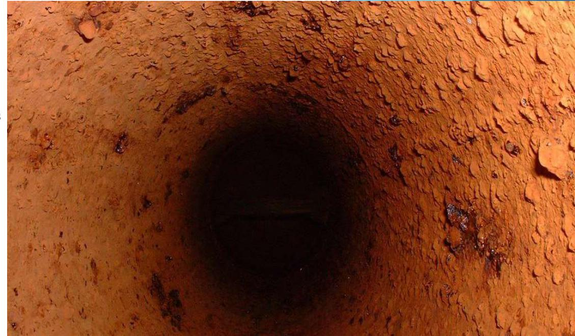
Corrosion du fer en milieu Oxygéné [28]
