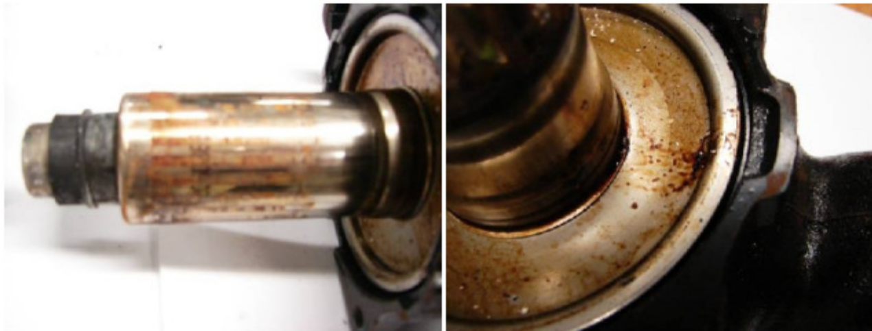
Figuur 10 Pompbus met kleverige afzetting
