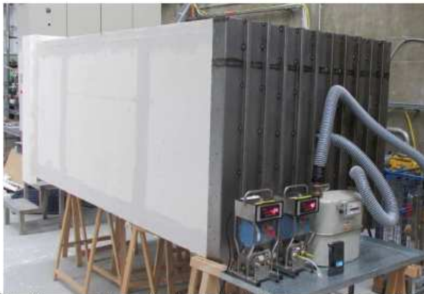
Figure 2 : Échantillon en essai. Au premier plan, l'extrémité obturée par une plaque métallique renforcée, et les instruments de mesure (débitmètre et manomètre)
